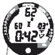
Obrázek 53 - Zpožděný režim porušení #2
