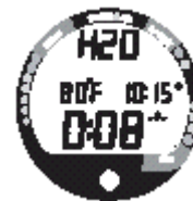
Obrázek 17: Režim na povrchu (jednotku opláchněte a vysušte)
