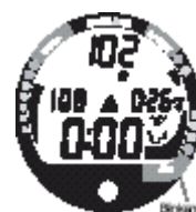
Obrázek 59 - Varování na vysokou hodnotu O2
