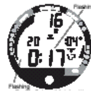
Obrázek 52 - Zpožděný režim porušení #1
