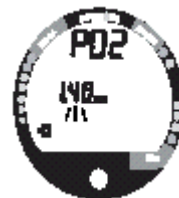
Obrázek 35 - Nastavení alarmu maximální hodnoty PO2
