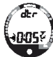
Obrázek 34 - Nastavení alarmu zbývajícího času ponoru
