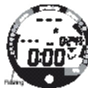
Obrázek 54 - Zpožděný režim porušení #3
