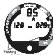
Obrázek 55 - Okamžité porušení - Režim měření (pod vodou)
