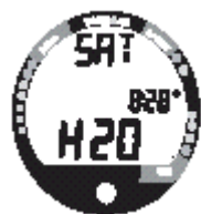
Obrázek 71 - Odpočítávání doby desaturace (Aktivační kontakty jsou vlhké)
