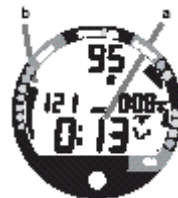
Obrázek 13: Zbývajících doba bezdekompresního ponoru
